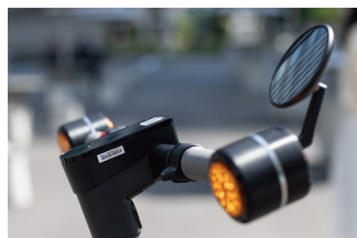
保安部品 (方向指示器、後写鏡、 警音器等) 搭載で公道走行可能
