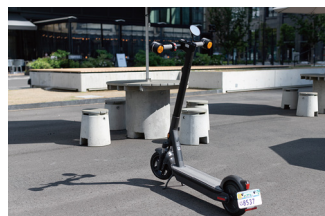
車両後部にナンバープレート 取付けステーを標準装備
